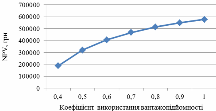
Рис. 3 – Графік зміни величини NPV досліджуваного логістичного ланцюга залежно від коефіцієнта використання вантажопідйомності транспортного засобу
