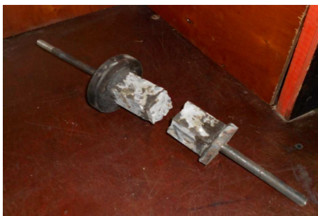
Рис. 2 – Характер разрушения при растяжении склеенных бетонных призм (по бетонному сечению)
