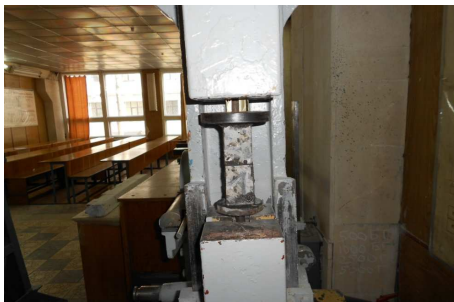
Рис. 1 – Испытание склеенных по торцам бетонных призм на растяжение в лаборатории ХНУСА
