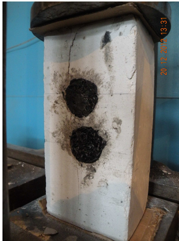
Рис. 4 – Разрушение образца с двумя заделанными базальтопластиком отверстиями
