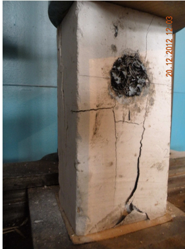
Рис. 3 – Разрушение образца с отверстием, заделанным базальтопластиком
