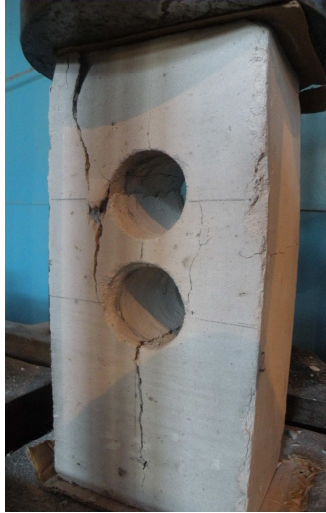
Рис. 2 – Образец из силикатного кирпича с двумя отверстиями, что моделирует начальную более протяженную вертикальную трещину
