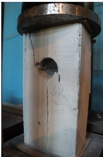
Рис. 1 – Разрушение образца из силикатного кирпича с одним отверстием
