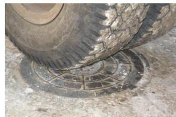
**Рисунок 5** – Натурно-эксплуатационные испытания люков смотровых колодцев из ВПКМ средней серии КС-ВК-60 (В-125)
