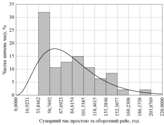
Рис. 3. Гама-розподіл, придатний для опису сумарного часу простою за оборотний рейс при перевезеннях до транспортної зони «Німеччина»
