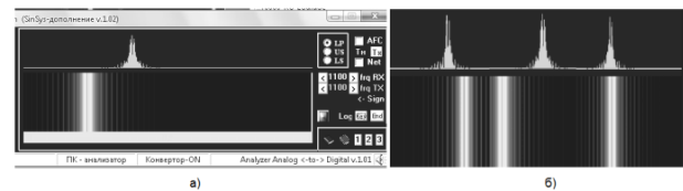
Рис. 2 Експериментальний спектроаналіз модульованих сигналів від перетворювачів «температура-частота»: а – інтерфейс програми контролю монотонного сигналу; б – інформаційні сигнали від різних джерел з частотами S_{TЧ1} , S_{TЧ2} , S_{TЧ3} .
