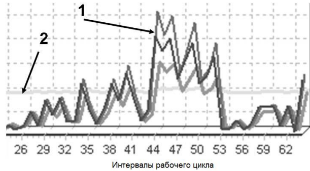
Рис. 1 Електронний запис навантаження ТЕП на ділянках робочого циклу: 1 – струм навантаження; 2 – напруга контактної мережі
