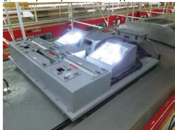
Рис. 1. Високошвидкісна оптична система вимірювання параметрів КП на JR Yamagata Shinkansen
