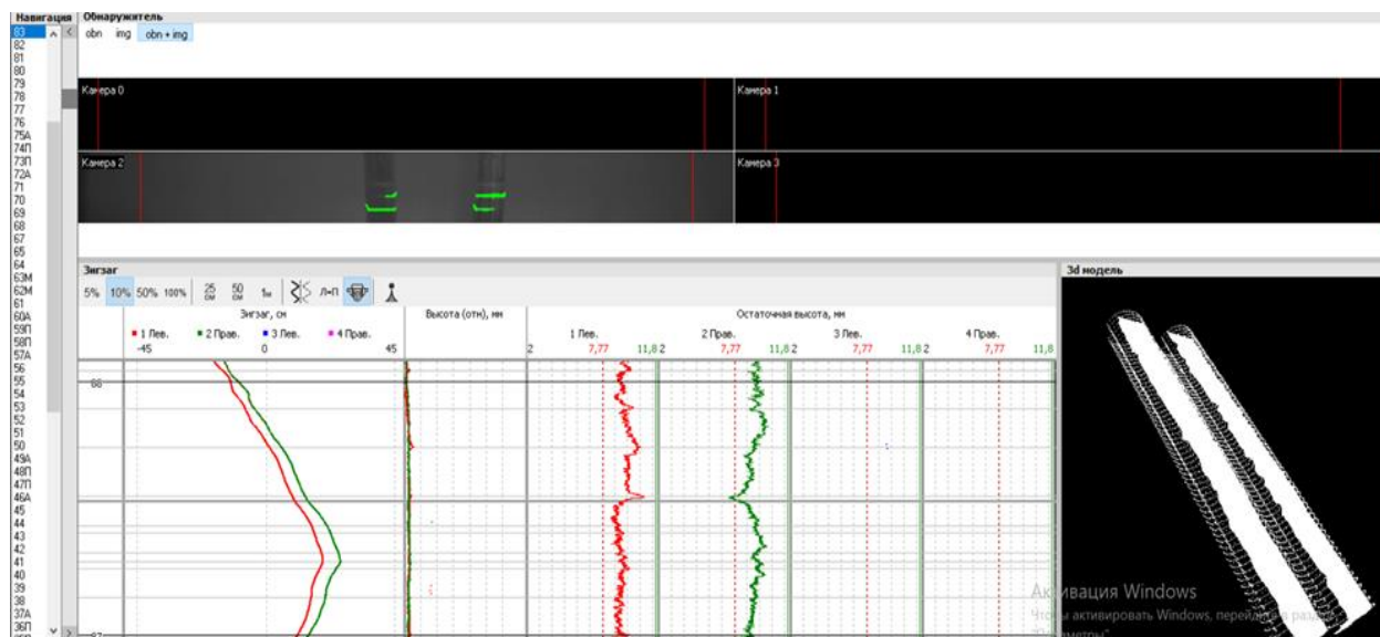
Рис. 3. Інтерфейс ПЗ для аналізу й обробки даних вимірювань лазерної системи діагностики КП
