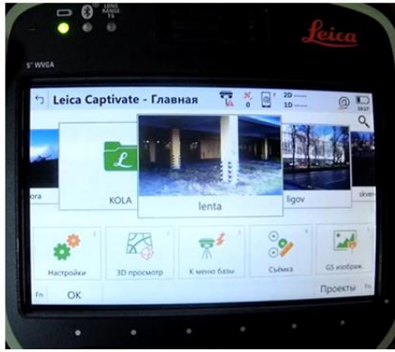
Рис. 4. Зображення послідовності визначення координат точок по знімкам на планшеті GNSS приймача Leica GS18 I
