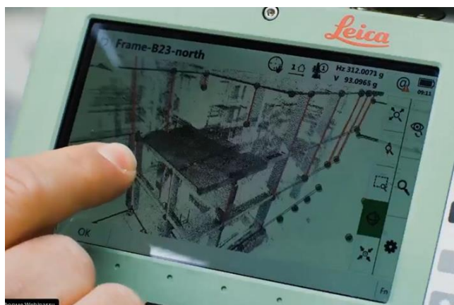
Рис. 2. Зображення 3D-моделі зі сканованих точок на екрані тахеометра Leica Nova MS60
