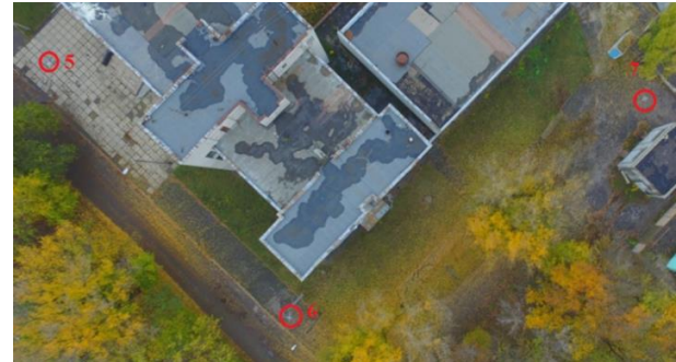
Рис. 2. Приклад маркування опознаків 5, 6 та 7
