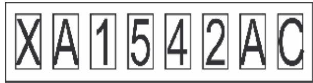
Рис. 3. Результат сегментації символів автомобільного номеру
