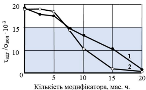
Рис. 5. Залежність величини співвідношення \tau_{адг} / \sigma_{вол} для композиту при контакті до скловолокна (1) та вуглеволокна (2) від кількості модифікатора – смоли E-181
