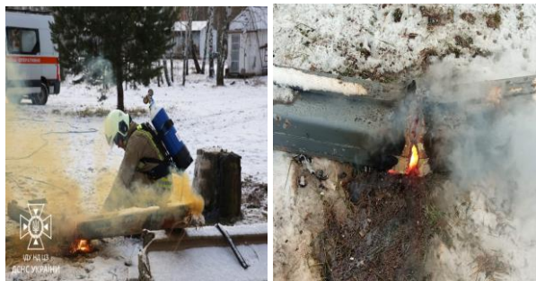
Рис. 8. Робочий момент різання сталевих квадратів та його зовнішній вигляд після різання
