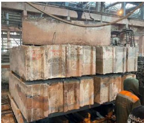
Рис. 7. Завантаження блоками плити ПД2-9,5 (М)
