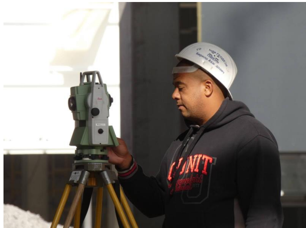
Рис.7. Проведення тахеометричного знімання
