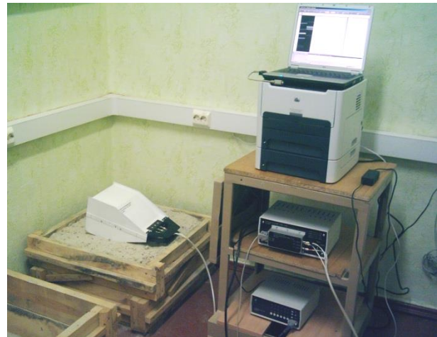
Рис. 1. Комплект георадіолокаційної обладнання, що призначений для визначення електрофізичних характеристик ґрунтів земляного полотна та дорожнього одягу.
