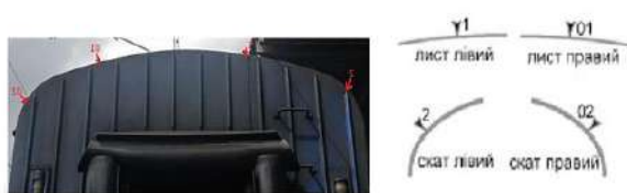
Рис. 3. Схема проведення вимірювань обшивки даху
