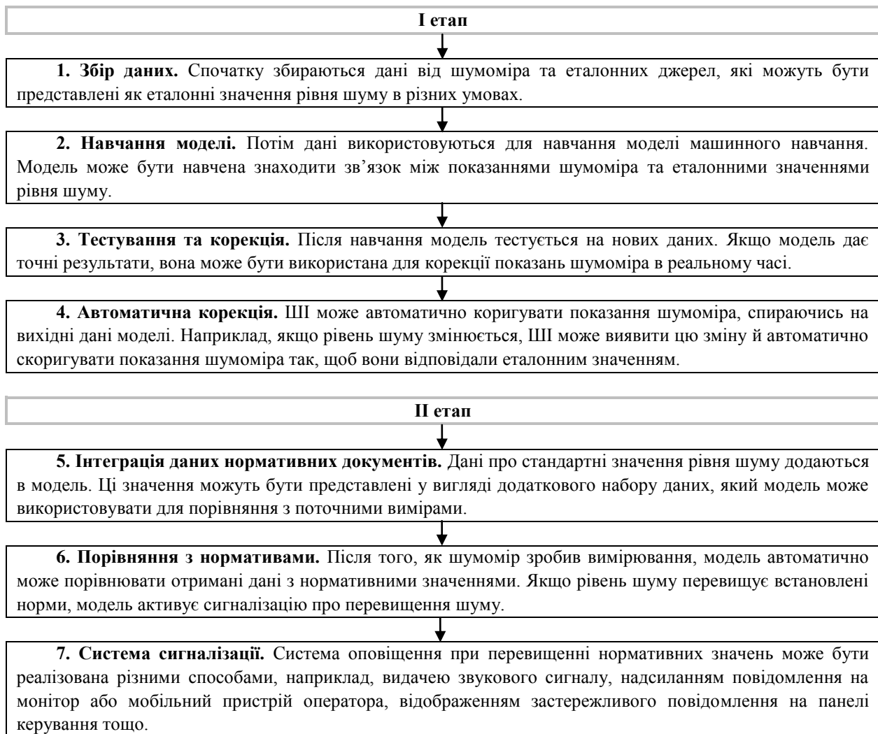
Рис. 2. Блок-схема калібрування шумоміра з використанням алгоритмів машинного навчання
