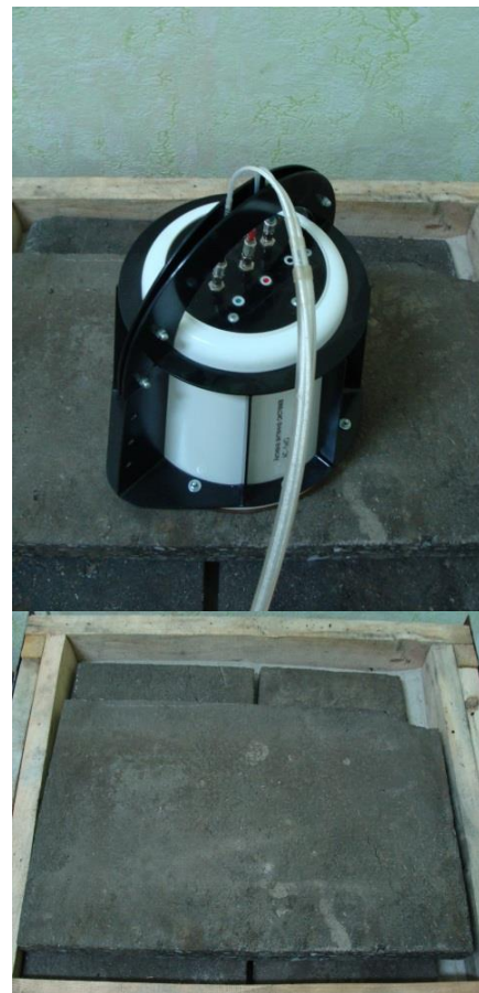
Рис. 4. Антенний блок та модель для пошуку підповерхневих тріщин
