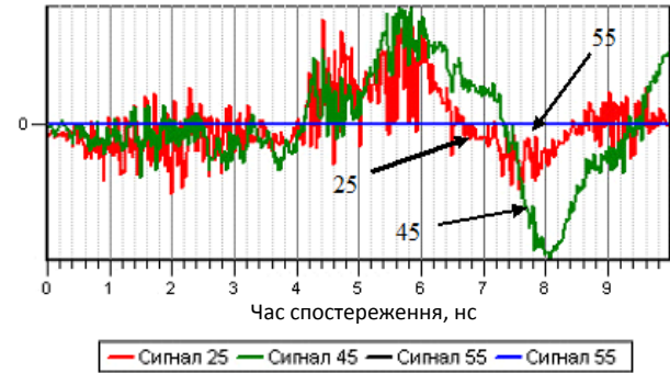
Рис. 6. Моделювання розповсюдження сигналу в нижньому шарі покриття: сигнал 55 – нормувальний – відсутність дефектів; сигнал 45 – наявність тріщини, що заповнена водою; сигнал 25 – наявність тріщини, що заповнена повітрям
