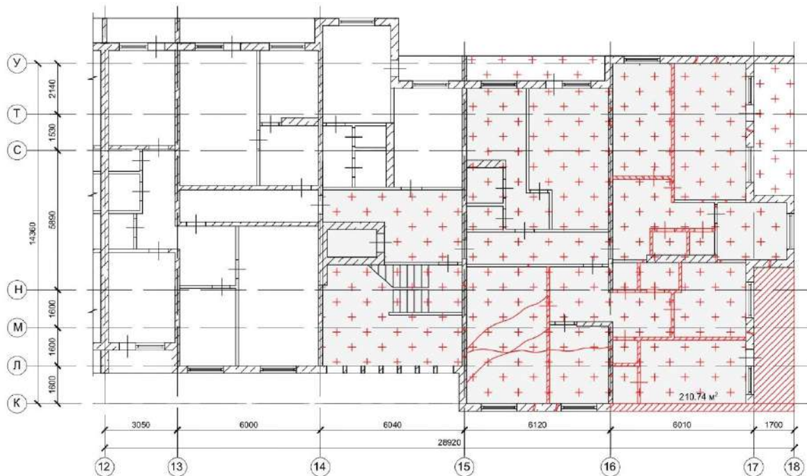
Рис. 4. Пошкоджені плити перекриття, що потребують відновлення.
